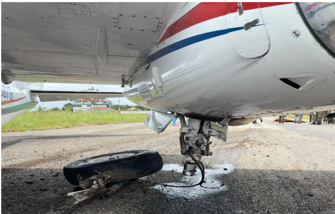
Fotografía No. 03 - Fractura del tren de aterrizaje izquierdo.
